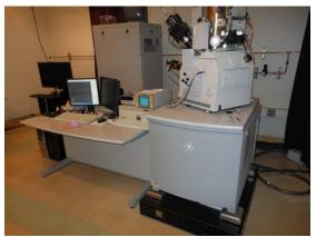
FEI Strata<sup>™</sup> FIB-SEM installed on TMC SEM-Base<sup>™</sup>
